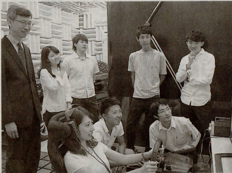
エンジン音と加速感、運転動作、視覚などとの関連を評価するドライブシミュレーター。左端が戸井武司教授＝東京都文京区の中央大理工学部
