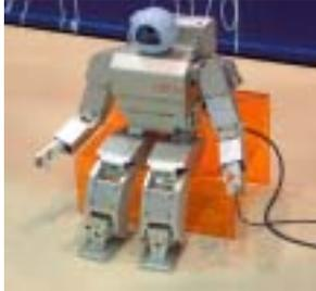
Fig.10 実験で利用するヒューマノイドロボット Hope 2
