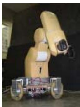
Fig.6 全方向移動台車に搭載された産業用ロボット
